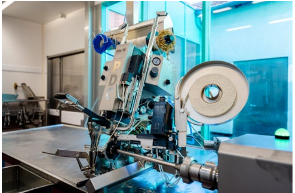
Die Landmetzgerei Mehl setzt auf den halbautomatischen Doppelclipper PDC 700 von Poly-clip System – eine passgenaue Lösung, die sich nahtlos in die Abläufe der Fleischverarbeitung integriert und Clippen und Etikettieren mit dem ES 6000 in einem Arbeitsgang vereint.
