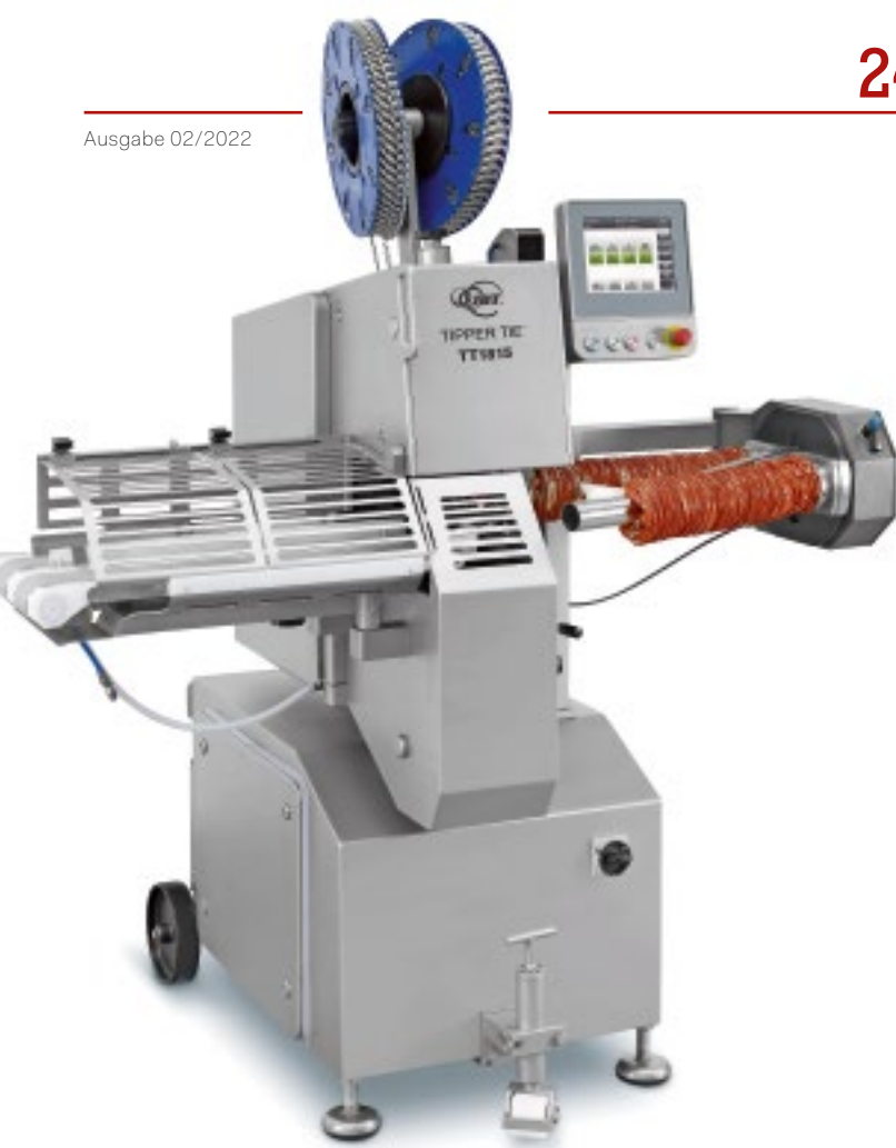
Doppelclip-Automat für Kunststoff-, Faser- und Collagendärme in einem breiten Kaliberbereich.
