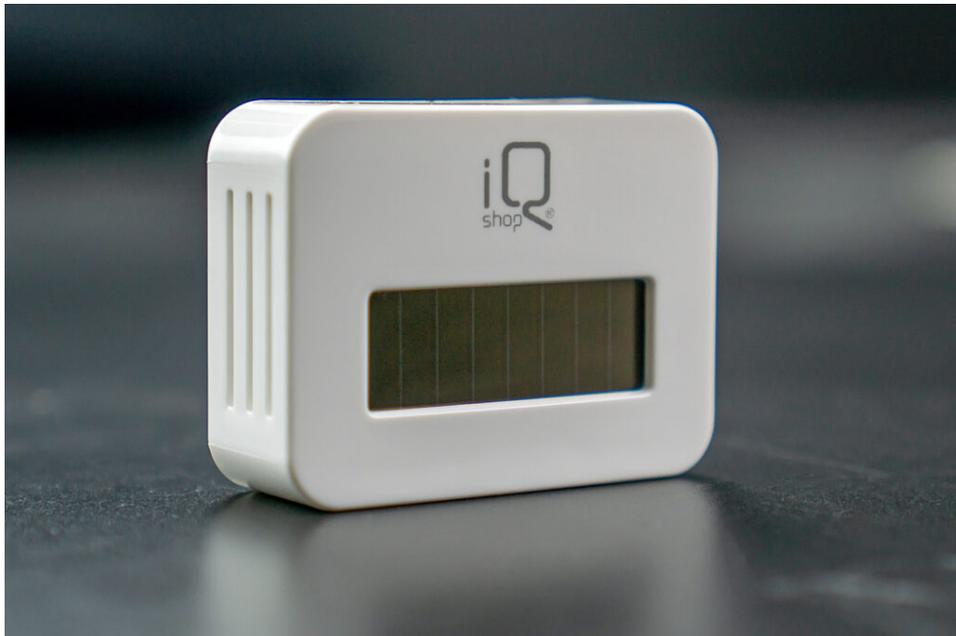
Der EnOcean-Sensor von Shop-IQ überträgt die Daten zur Temperaturkontrolle per Funk.
