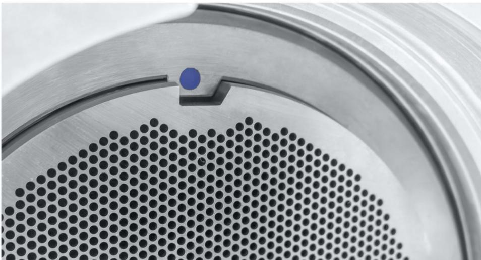
*Durch Anpassung des Schneckenzapfens, des Keils im Schneckengehäuse und der entsprechenden Gegenstücke in Messern und Lochscheiben ( hier im Bild), sind die verdrehsicheren Seydelmann Schneidsatzteile nur noch in eine Richtung einsetzbar. © Beigestellt*
