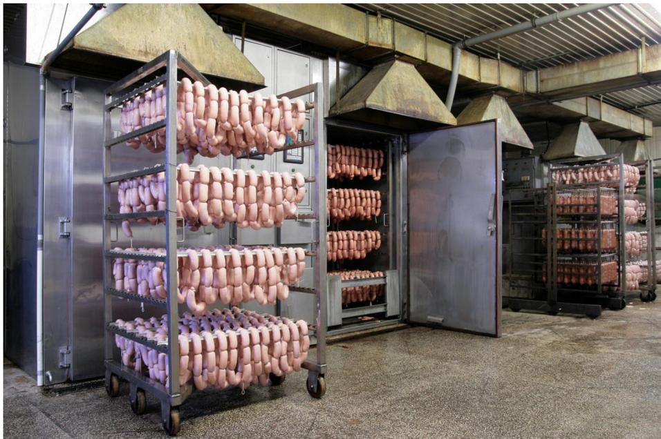
*In der Fleischindustrie werden in 90 Prozent der Fälle für die Prozesswärme Temperaturen von mehr als 100 Grad Celsius benötigt. © BKtech*
