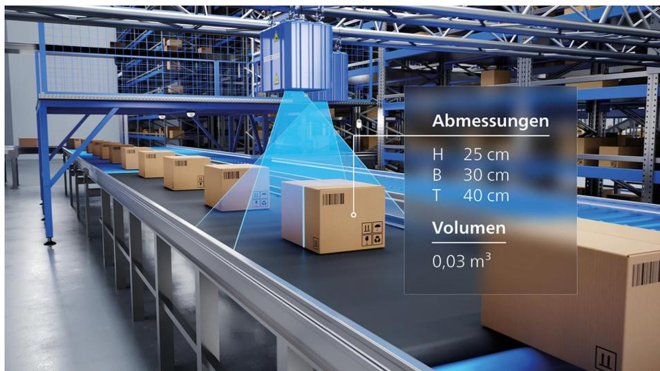
In Verbindung mit den marktführenden Wägelösungen von Bizerba schaffen die beiden Anbieter ein ganzheitliches, voll integriertes Komplettsystem zur Volumen- und Gewichtsmessung. Mit diesem lassen sich wenige Zentimeter große Waren sowie komplex kommissionierte Paletten vermessen.
