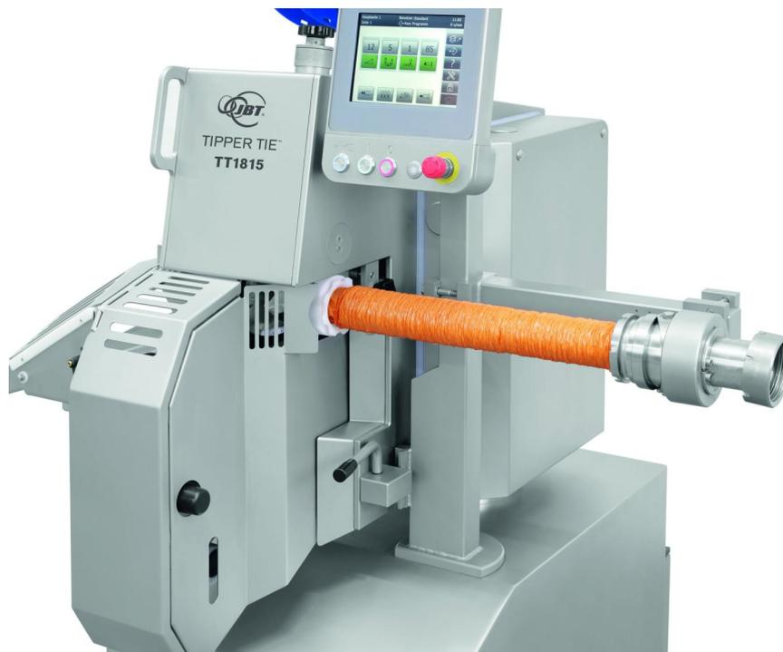
*Doppelclip-Automat für Kunststoff-, Faser- und Kollagendärme in einem breiten Kaliberbereich. © Beigestellt*
