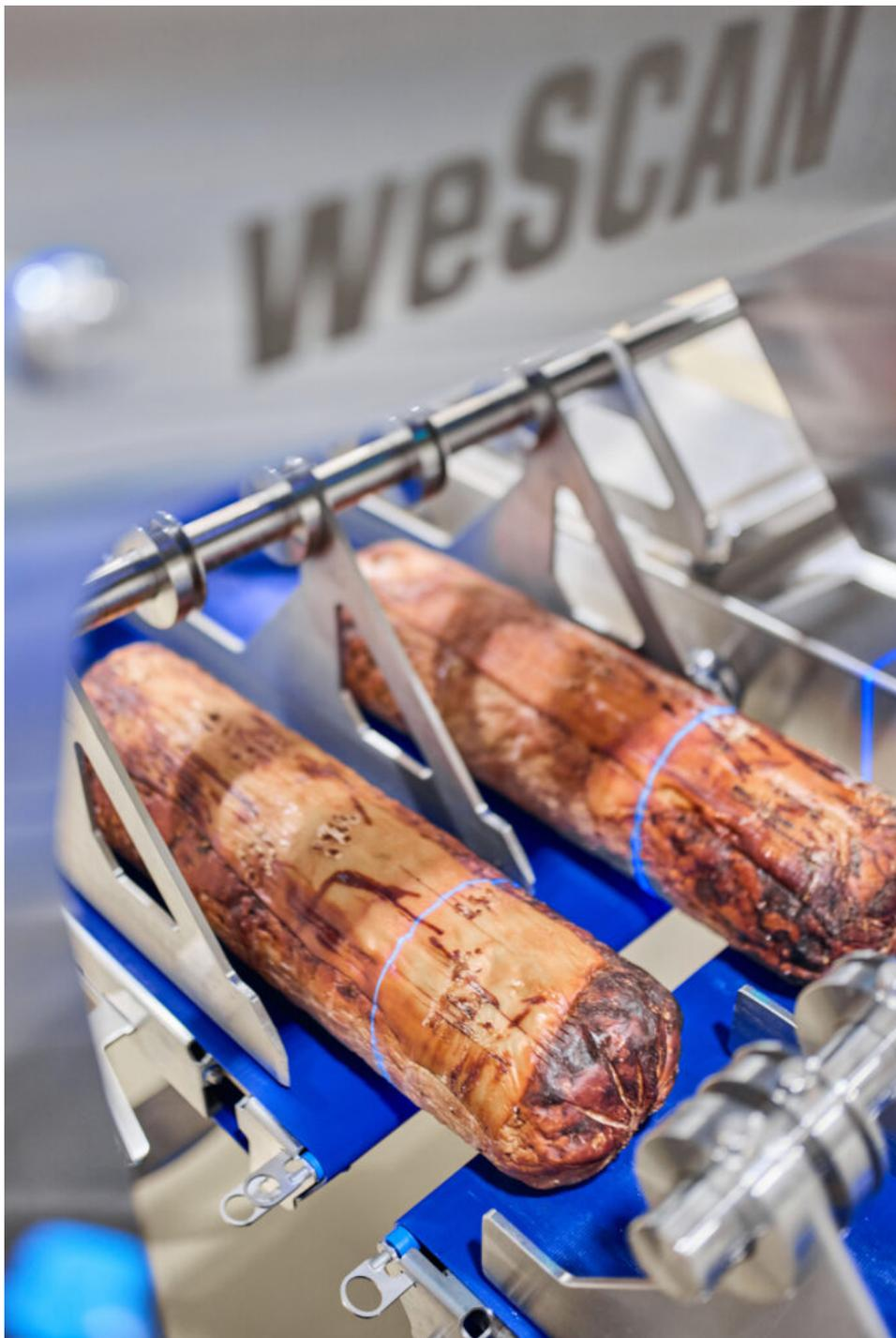
Die integrierte Variotechnologie erlaubt die unabhängige Produktzuführung auf bis zu vier Spuren. © Weber Food Technology
