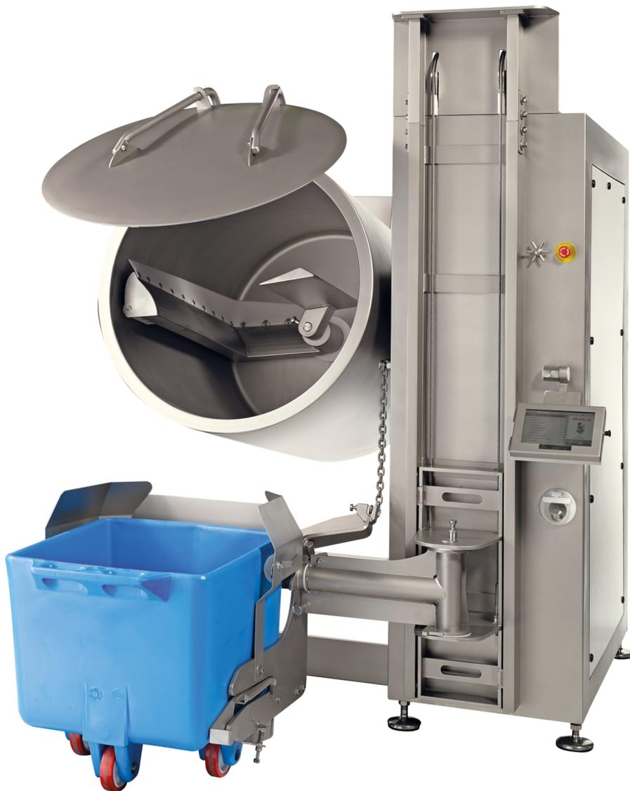
*Ein gefragtes Modell ist die Original MPR 900 mit einem Behältervolumen von 900 Liter und drei Viertel maximaler Füllmenge. © Beigestellt*
