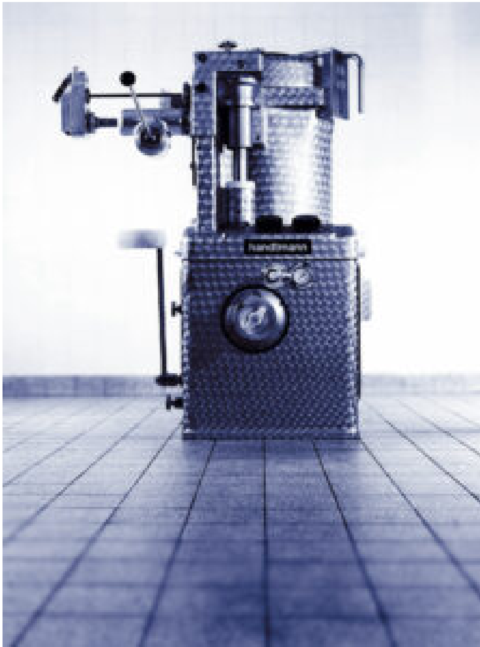
Verkaufsschlager: Die ab 1961 gebaute Handtmann Portioniermaschine FA 40-70 für die Wurstherstellung markiert den Durchbruch. © Beigestellt
