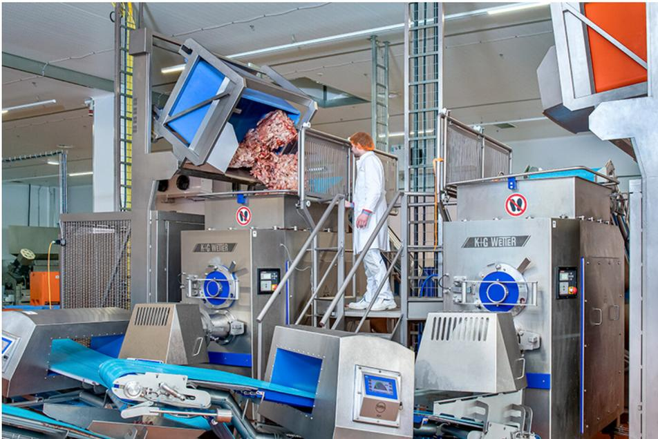
*Herzstück der Nassfutter-Produktion bei VetConcept sind zwei AW 280 von K+G Wetter. Die Industrie-Automatenwölfe mit einem Schneidsatzdurchmesser von 280 mm verarbeiten Gefrierfleisch und knochenhaltige Rohstoffe für aktuell bis zu 17.000 Tonnen Nassfutter pro Jahr. (©2023 PSV NEO GmbH)*
