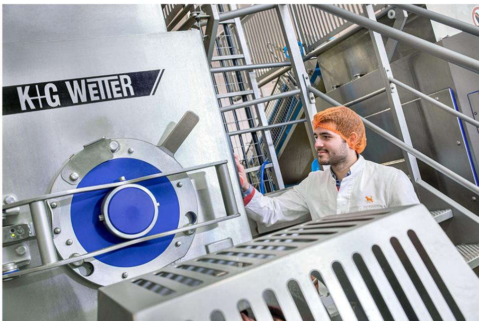
*Alle Maschinen von K+G Wetter sind konsequent auf Hygienic Design optimiert: Durch das Gehäuse aus handpoliertem Edelstahl und sorgfältig glatt geschliffene Schweißnähte bringen die Automatenwölfe optimale Reinigungseigenschaften mit. Bei VetConcept können die Mitarbeiter von Betriebsleiter Arthur Schäfer das CIP-System zudem direkt an die Hinterkopf-Reinigung der Zubringerschnecke und die Spülkammer anschließen. (©2023 PSV NEO GmbH)*
