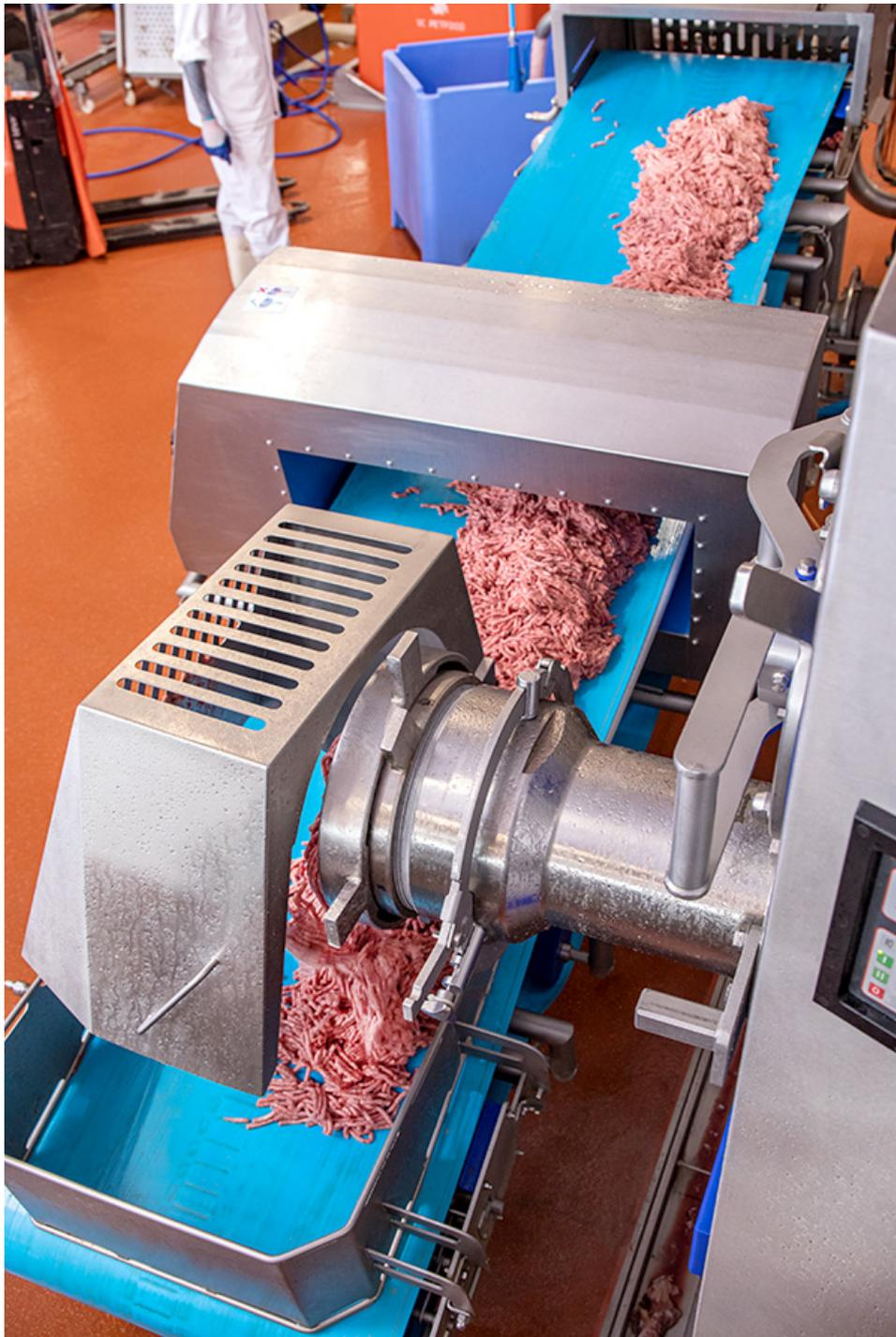
*Die Vorschneider-Stützeinrichtung reduziert den Druck auf den Schneidsatz erheblich – für eine höhere Standzeit der Schneidsätze, reduzierte Schleifzyklen und ein stets erstklassiges Schnittbild. (©2023 PSV NEO GmbH)*
