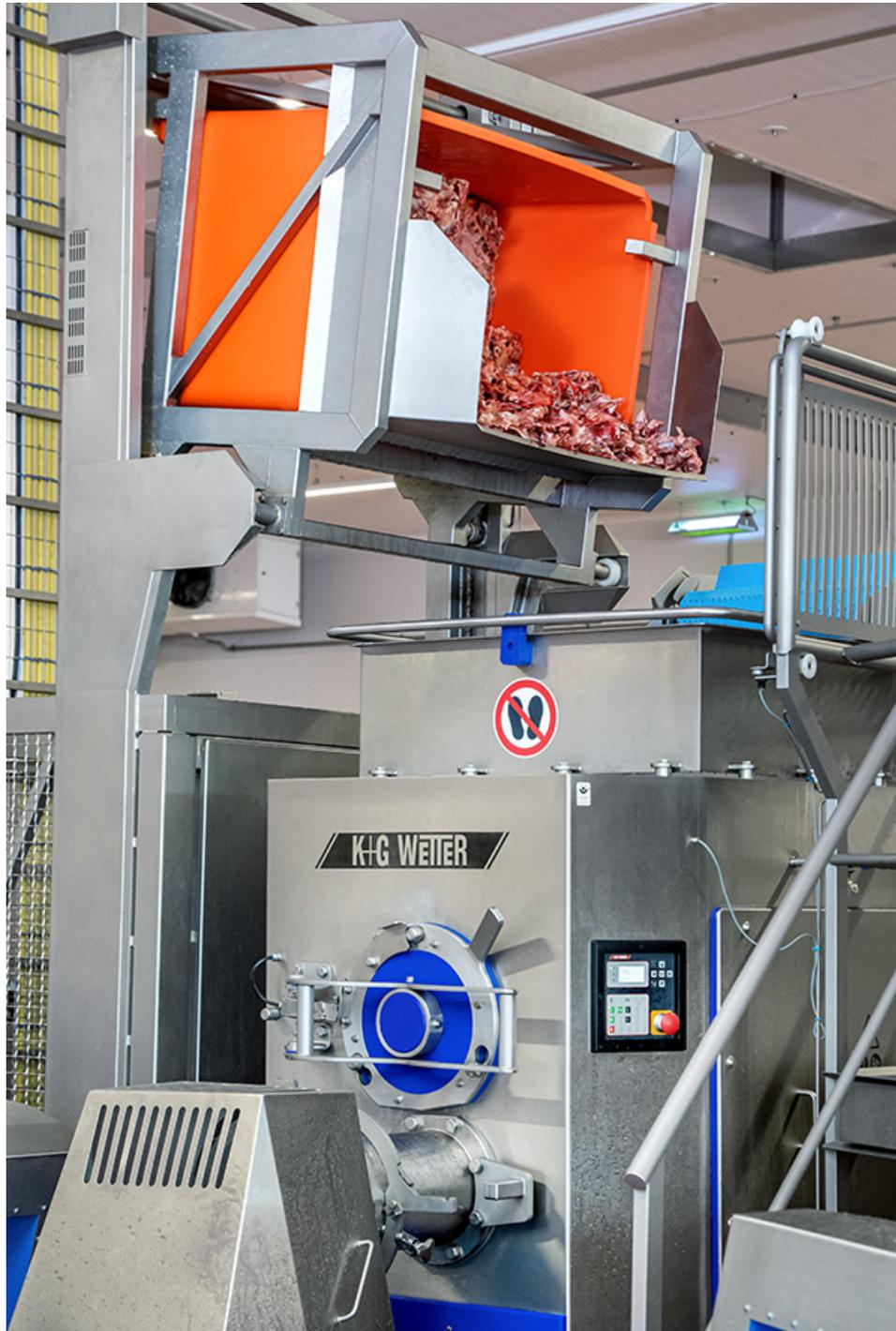
*Die Automatenwölfe können unterschiedlich beschickt werden: je nach benötigten Ausgangsmaterialien und Rohstoffen per Band oder Paloxe. Das sorgt für maximale Flexibilität für eine Vielzahl von Produkten. (©2023 PSV NEO GmbH)*
