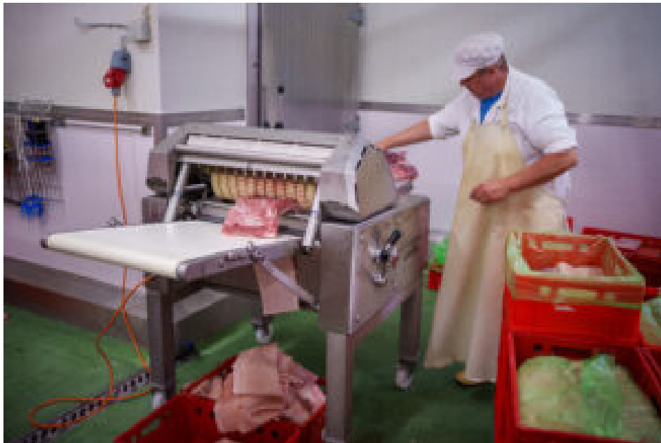
Die MAJA Bandabschwartmaschine BXAplus 554 gibt es bei Strasser und Laska. © Gasselich
