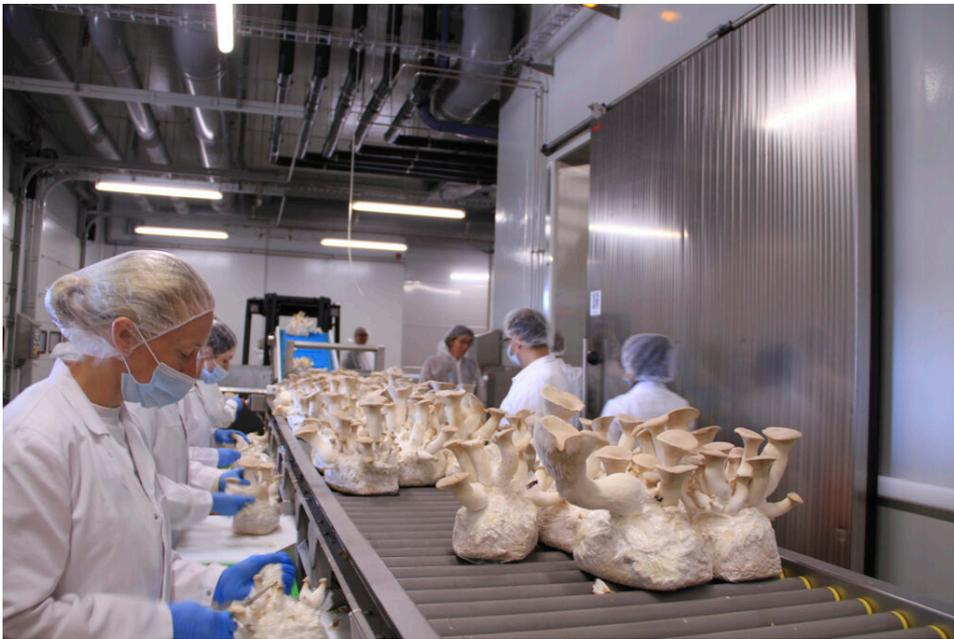
*Die fertigen Kräuteseitlinge werden im Handbetrieb vom Nährboden geschnitten, dieser wird übrigens in einer Biogasanlage weiterverwertet.*
