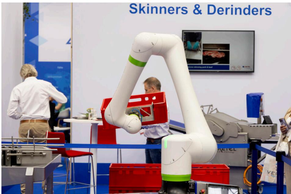
□□□ Ein Highlight am Cretel-Stand auf der IFFA: der Cobot, der vollautomatisch Kisten vor und nach der Waschmaschine stapelt und entstapelt – ein echter Publikumsmagnet. Die smarte Lösung steht exemplarisch für den neuen Anspruch an ganzheitliche Hygienekonzepte in der Lebensmittelverarbeitung. © Matthias Wenger
