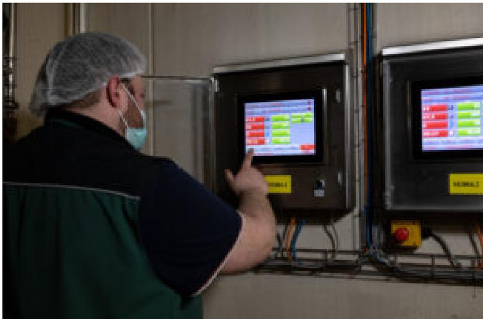
*Die Steuerung der Anlage läuft über die Touchscreens, die mittels Schnittstelle zum hauseigenen Computersystem die Herstellung der Fleischwaren jederzeit überwacht. © Beigestell*
