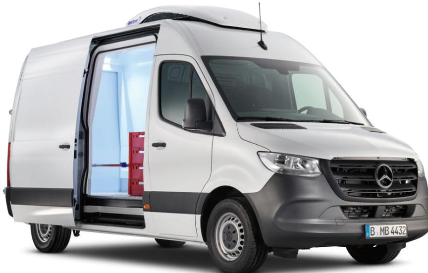
*Sprinter von Kerstner: Der Kerstner Kühlhausbau ist verfügbar für den Sprinter Kastenwagen 3,5 t mit Hochdach (D03) und dem Radstand 3.665 mm. Durch die elektrisch betriebene Dachkühlanlage ist kein Nebenantrieb notwendig. Das Durchlademaß zwischen den Radkästen beträgt 1.235 mm, dadurch ist auch eine Querbeladung von Europaletten möglich. Durch spezielle Doppeldichtungen an den Laderaumtüren kommt es zur Verbesserung der Isolationsleistung. © Beigestellt*
